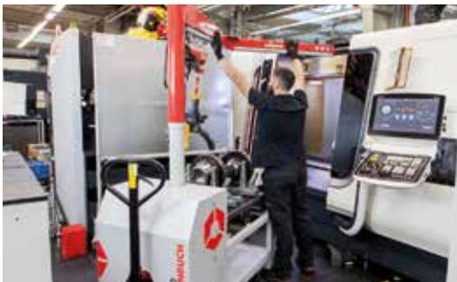
Positionieren des Rüstmobils vor der Maschine. Ohne Spannmittel wird der Schwenkarm ausgefahren und so die perfekte Position ermittelt.
