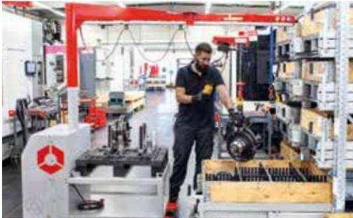
Alle benötigten Spannmittel können auf der Abstellfläche des Rüstmobils platziert werden. Zur Ablage steht die Fläche von einer halben Europalette zur Verfügung.
