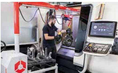
Spannmittel mit Schwenkarm von der Abstellfläche aufnehmen, an der Spindel positionieren und montieren.
