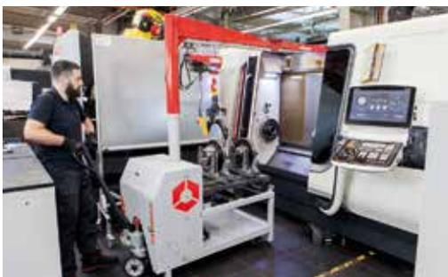
Nach dem Absenken des Rüstmobils ermitteln integrierte Sicherheitsabfragen den sicheren Stand und geben das Go für den tatsächlichen Rüstvorgang.
