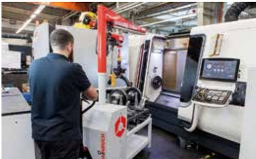
Rüstmobil wird inkl. der benötigten Spannmittel an die Maschine gestellt. Dies kann heute die Maschine A sein und morgen die Maschine B.
