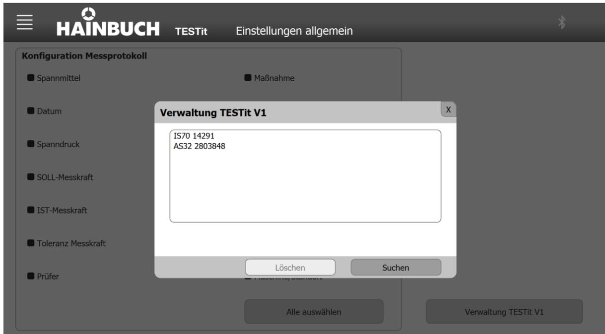
Wird der Button »Suchen« betätigt, so wird nach TESTit V1 Geräten gesucht, die eingeschaltet sind und sich in Reichweite befinden.
