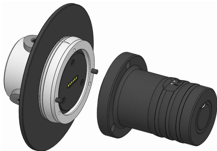
2. TEST Modul und IT Modul auseinanderziehen und dadurch trennen.
